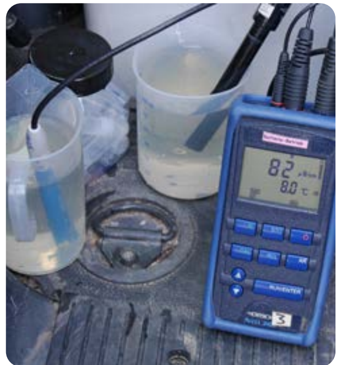
Abb. 5: Messgerät Multi 340i für die Gewässerchemie der Firma WTW (Foto: Ulrich Braukmann)
