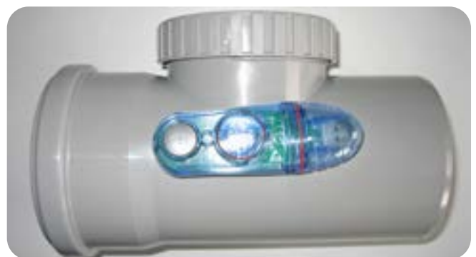
Abb. 1: Minilogger Microlab Lite, Firma fourtec Ltd. wurden sowohl für die Wasser- als auch für die Lufttemperaturmessungen eingesetzt (Foto: Julia Krawina)
