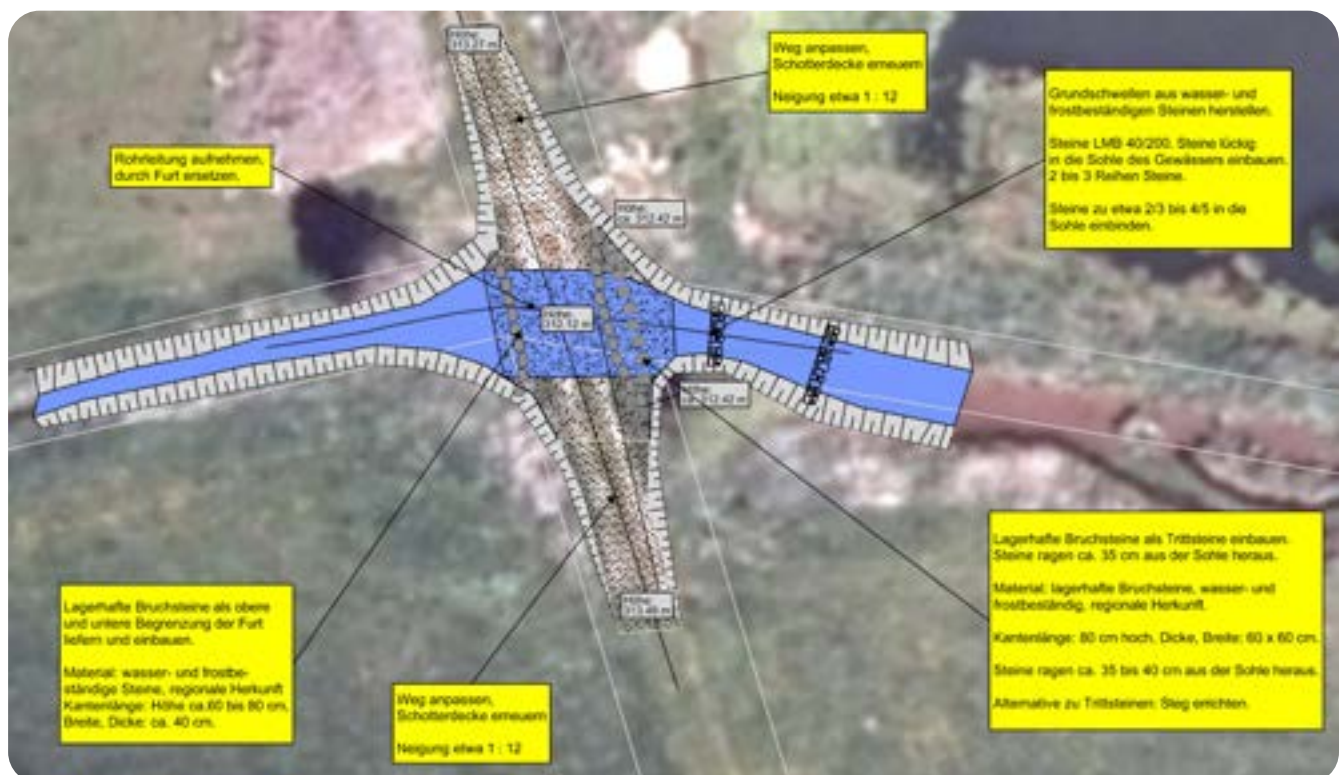
Abb. 8: Prinzipskizze Furt, Lageplan © WERNER HAAB 2010
